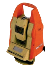
Le théodolite, monté sur un trépied, permet de mesurer des angles dans les plans horizontal et vertical. En topographie, il est utilisé dans les mesures d'un levé du territoire (levé topographique).
