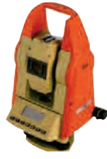
El teodolito, montado sobre un tripode, permite medir ángulos en los planos horizontal y vertical. En topografía, es utilizado en las medidas de un trazado del territorio (relevamiento topográfico).
