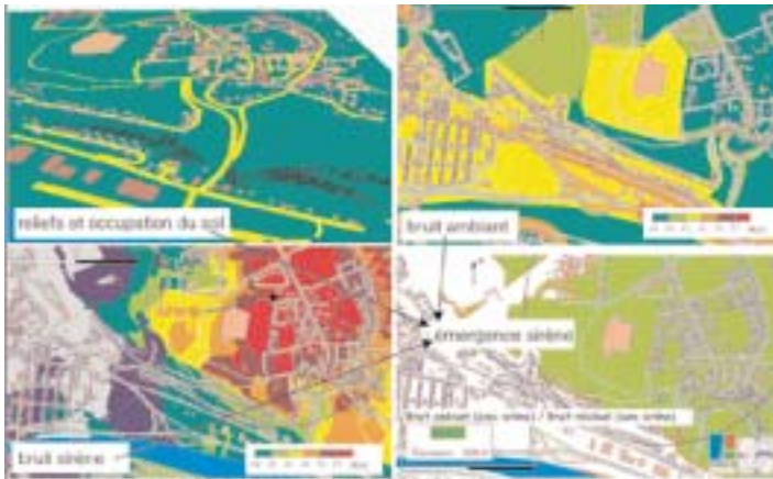
Figure 5 : Prise en compte de la 3D (sol, sur-sol) et du bruit ambiant dans la propagation acoustique des sirènes d'alerte des populations – Taking account of the 3D aspect (ground, above-ground) and of the ambient noise in acoustic propagation of population-warning sirens. Source : CODAH
